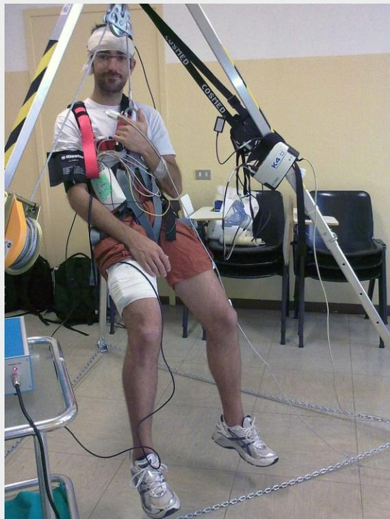
**Figura 1:** test di sospensione inerte in imbracatura.
